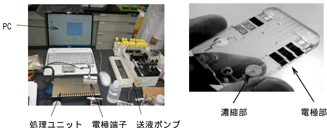
図1 CSV測定装置及び検出用カートリッジの外観
